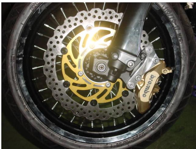
ディスク径 310φ のフローティングマウントウェーブ形状ディスクと Brembo 65mm ピッチ 4Pot 4Pad キャスティングキャリパー及び専用キャリパーサポートの SET です。
