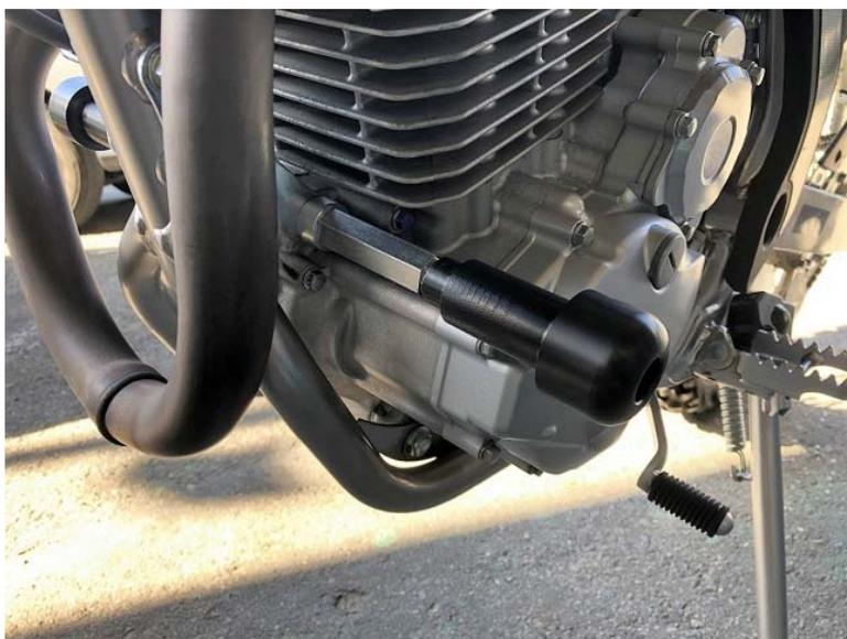
衝撃が加わると、取り付けボルトが折れる事により、衝撃力を分散させ他の部分に及ぼす損傷を軽減させる製品です。
