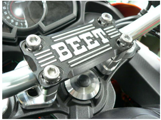
装着画像のハンドルはグレーですが製品はブラックとなり、スイッチBOXの穴あけ加工が必要となります。 ブレース無しKIT
