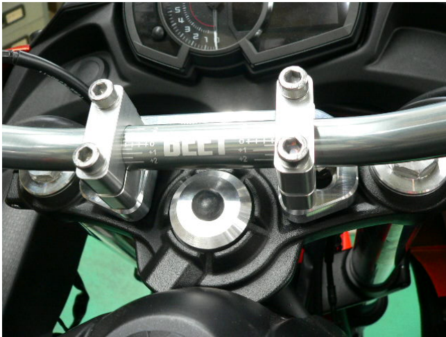
装着画像のハンドルはグレーですが製品はブラックとなり、スイッチBOXの穴あけ加工が必要となります。 ブレース無しKIT
