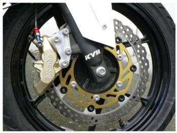
好評のビッグウェーブディスク KIT に Brembo 65mm ピッチ対向 4POT キャリパー対応版が登場!
