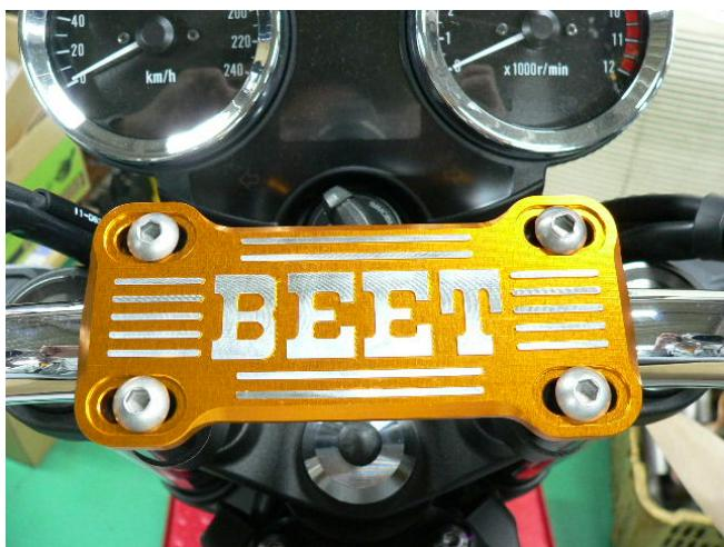
対応車両ピッチ 43mm 幅 95 mm～115 mm
