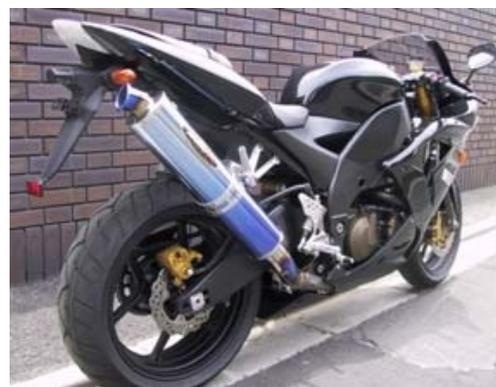
〈軽量〉ノーマルマフラー重量 約 3.6kg、NEW NASSERT-Rチタンスリップオン 約 2.8kg
