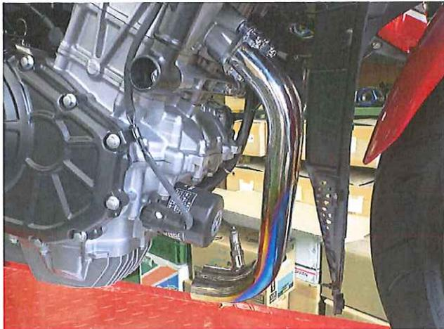
(3) 集合部をエキゾーストパイプに差し込み、各パイプのフックをスプリング引きをします。
