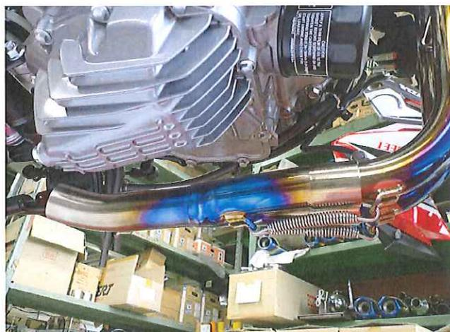
(4) サブサイレンサーを集合部に差し込み、スプリング引きをしてから、付属のダンパーカラー（黒）、ボルト（M8×50）、ワッシャー（外径 22φ）を使用し、マフラーステーの裏側から付属のワッシャー（外径 18φ）、ナットで仮止めします。
