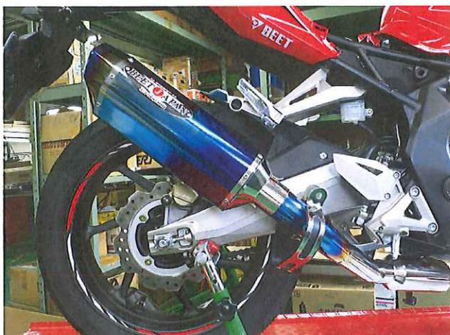
(7) サイレンサーバンドの位置を調整し、付属のダンパーカラー(シルバー)、ボルト(M8×45)、はめ込みカラー、ワッシャー(18φ)を使用し、仮止めをする。
