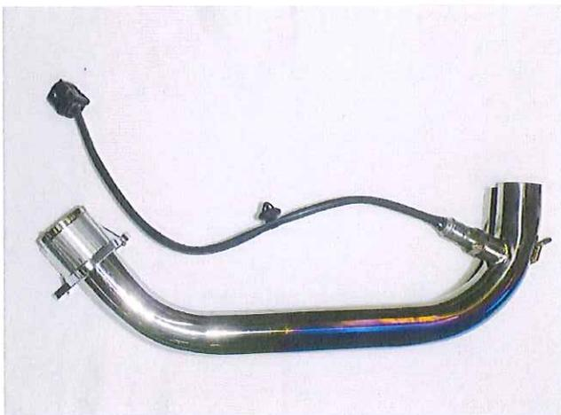
(2) エキゾーストガasketを付属のガasketと交換し、エキゾーストパイプを仮組みし、O2センサーの結線を復帰させます。
