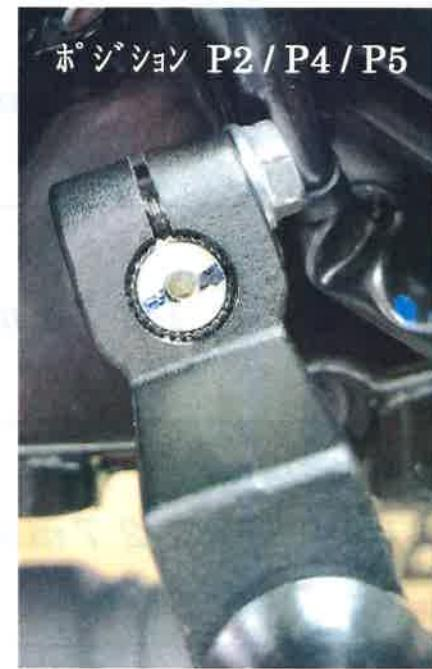
※ 最初の取付け時は、好みのポジションで取付けて下さい。走行時は必ずご自分に合ったポジションを選択し、チェンジ・ブレーキ両側のポジションが同じである事を確認して下さい。
