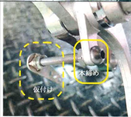
ブレーキペダルのネジ部に丸キャップボルト M6 × 55 を締め込み、裏から左図のように、M6 ナットで本締めし完全に固定します。
