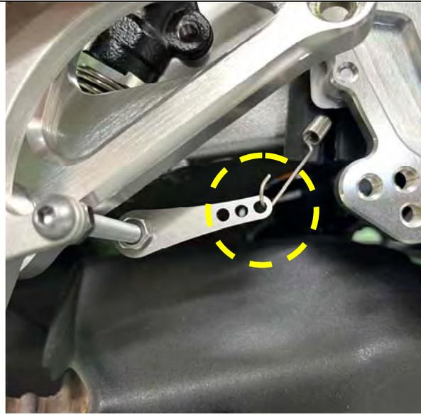
ステップホルダーを丸キャップボルト M8×15 で、好みのポジションに取り付ける。
