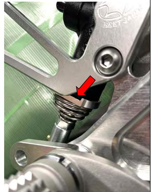
丸キャップボルト M8×45 と M8 ロックナットで、13.5mm 厚カラーと挟みピロボールに取り付け、マスターシリンダーとブレーキペダルを接合する。
