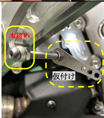
ブレーキペダルのネジ部に丸キャップボルト M6×55 を締め込み、裏から左図のように、M6 ナットで本締めし完全に固定します。
