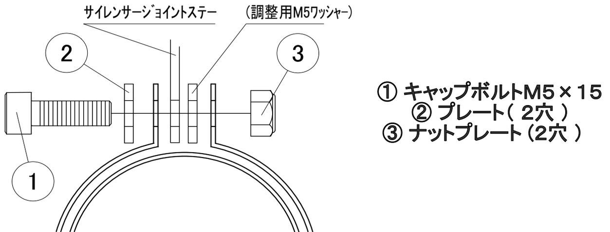
**※ サイレンサーバンドのボルトは締めつけずに、バンドが回る程度にして下さい。**
