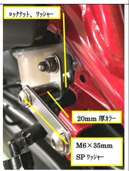
Pos2、Pos4、Pos5 は、左上図の様に、ショートステーを使用し、 リザーバータンクをオフセットさせ取り付ける。
