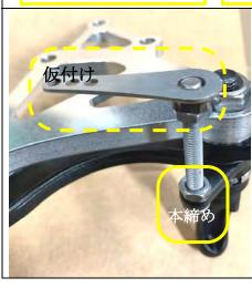
ブレーキペダルのネジ部に **丸キャップボルト M6×55** を 締め込み、裏から左図のよう に、M6ナットで本締めし完 全に固定します。
