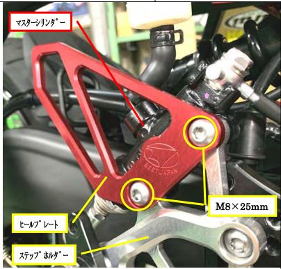
左図の様に、ヒールプレートとマスターシリンダーを丸キャップボルト M8× **25mm** で、ステップホルダーを挟み込む様に取り付ける。
