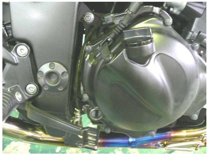
(5) 付属のタイラップで、写真のようにO2センサーコードを取り付けます！
