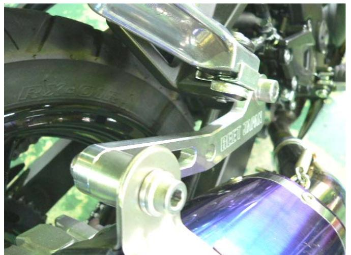
(8) 各部のクリアランスを確認してから、各ボルトを本締めします！
