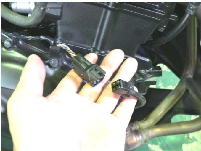
(2) O2センサーを写真のように、取り外します！
