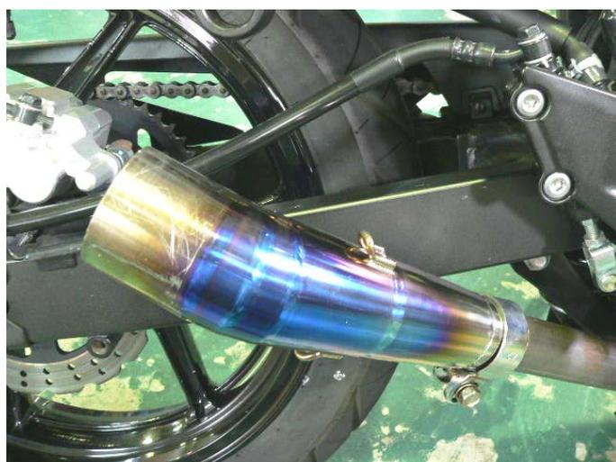
(3) サイレンサーを差し込み、スプリング引きします！
