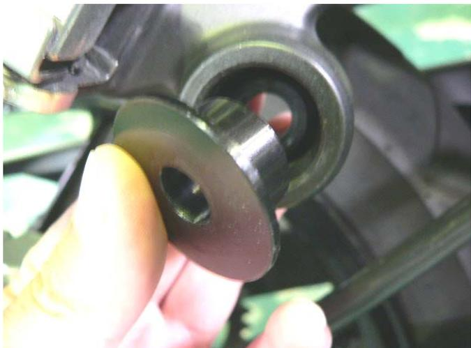
※まれに車両の個体差により、カラーが最後まで入らない場合は、カラーの角を削るなどして、取り付けてください。
