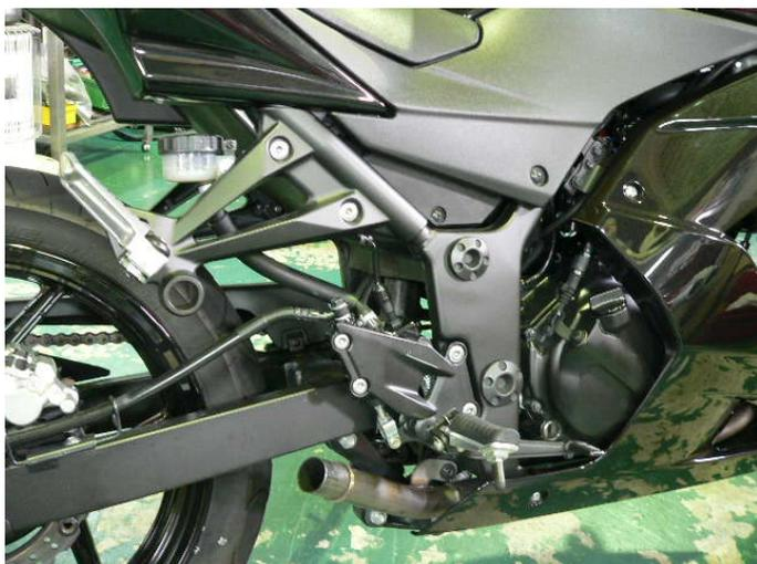
(2) テールパイプに付属の新品ガスケットを取り付けて、ノーマルエキパイに差し込み
