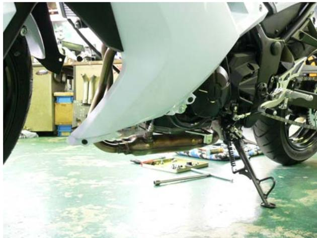
(2) エキパイにテールパイプを差し込みスプリング引きして、純正エキパイナットで取付けます。
