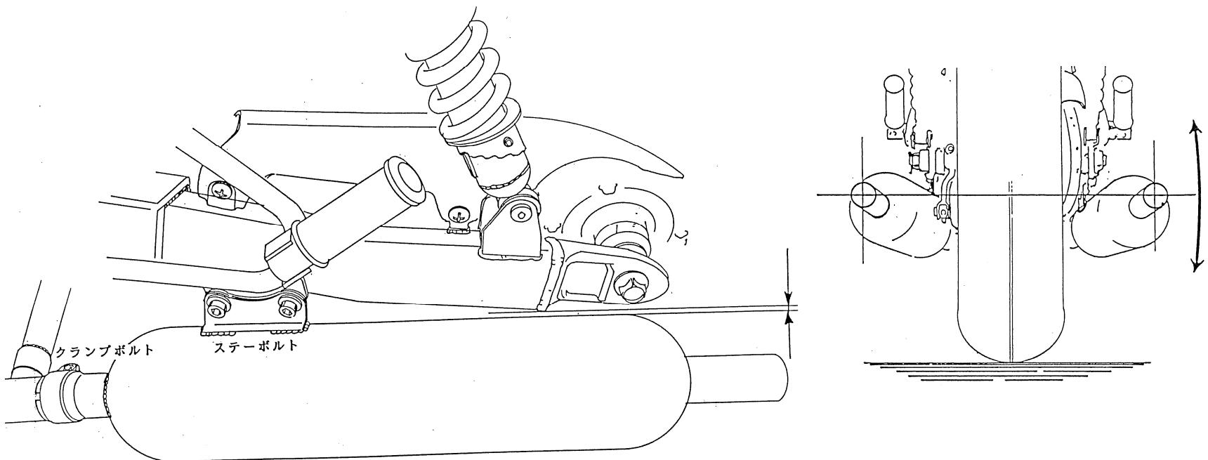
★最後にマフラー全体をしっかりと脱脂して下さい。拭き残しがあるとエンジン始動後に、排気熱により色むらが発生します。エンジンを始動させ、排気漏れのチェックを必ず行ってください。以上で取り付け作業は終了です。
