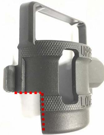
ブレーキ側ステップホルダーをポジションプレートに、好みのポジションに丸キャップボルト M8×15 で本締めします。
