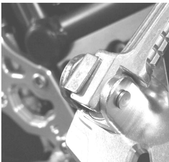
タンデムホルダーに純正のタンデムステップをそのままのセットで移植し純正Eクリップを止めます
