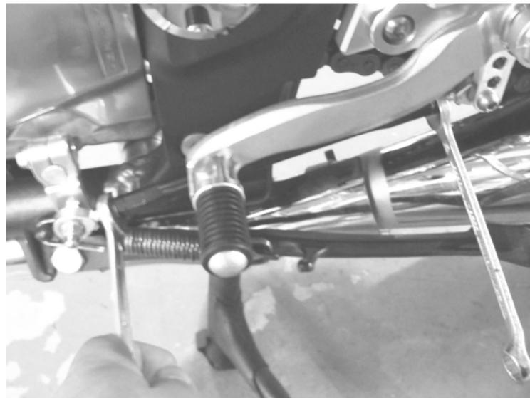
ペダルの角度の調整、チェンジカム・チェンジペダルカム・ピロボールの取り付けがおかしくないかを確認してから、
