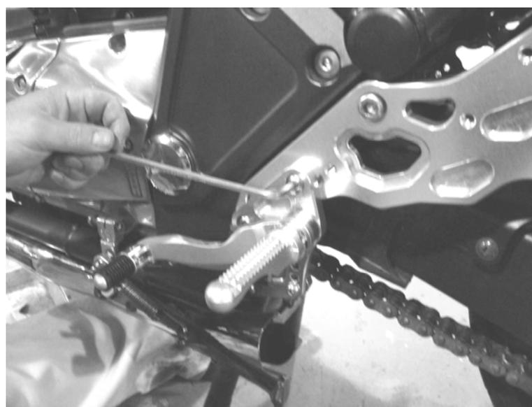
エンジン側のチェンジカム・ピロボールを交換しチェンジロッドを組み付けます。
