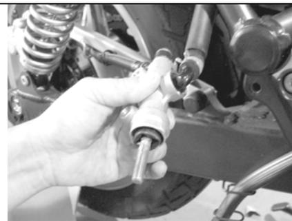
マスターシリンダーの純正のサークリップを取り外しノーマルプッシュロッドを付属のプッシュロッドとプッシュロッドワッシャに交換する。
