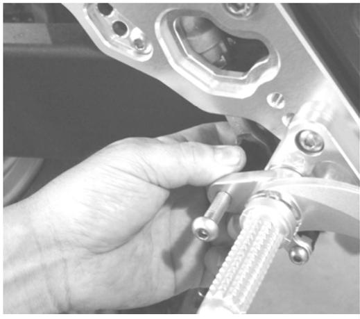
ブレーキペダルカムとリアマスターシリンダーのピロボールを、M8×60 丸キャップボルトとM8Uナットで接合します。
