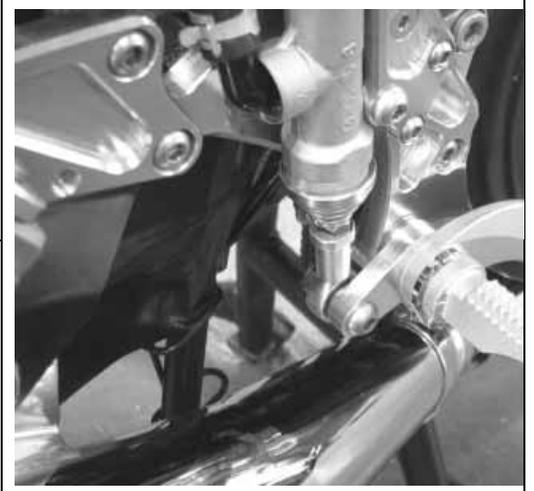
そして、ブレーキペダルの角度が合わない場合は、ブレーキペダルカムとピロボールを固定している M8 ボルト をブレーキペダルカムから取外して、ピロボール自体を回転させて行います。
