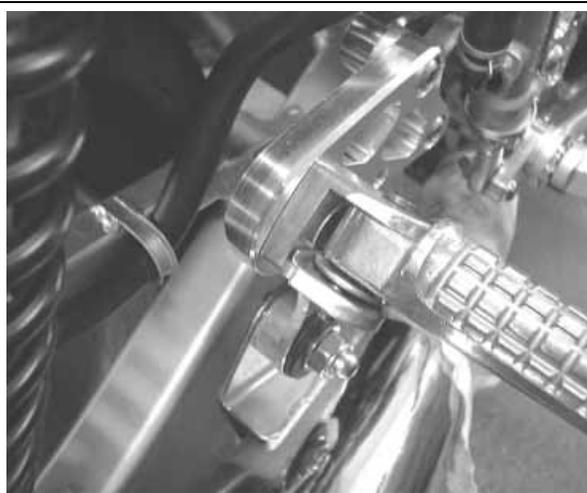
タンデムホルダーに純正のタンデムステップをそのままのセットで移植しクリップを止めます
