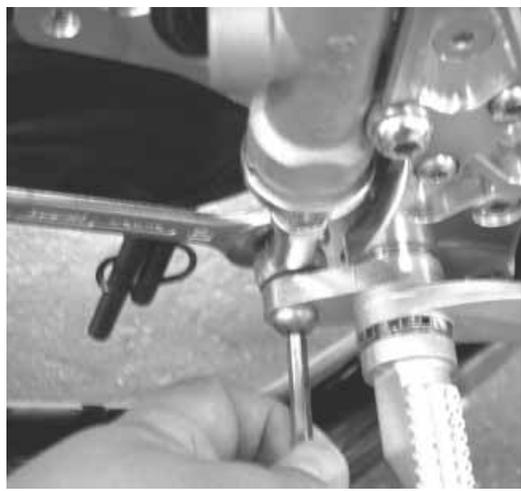
ブレーキペダルカムとリアマスターシリンダーのピロボールを、M8 x 30 丸キャップボルトとM8Uナットで接合します。
