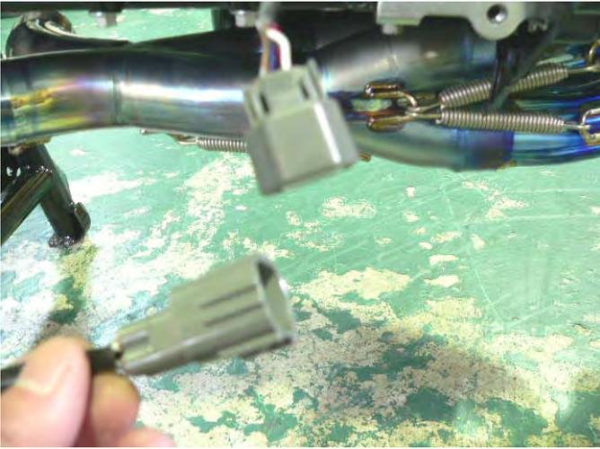
(5) テールパイプ右にO2センサーを取り付けて、集合部Bに差し込みスプリング引きして純正テールパイプステー取り付けボルトを使って写真のように仮止めします。
