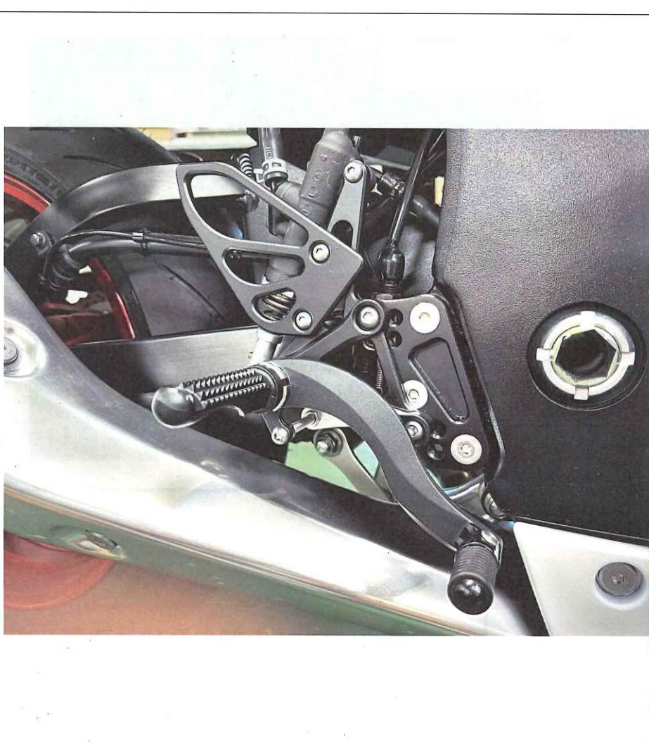
ブレーキペダルの高さが合わない場合は、純正 M8 ナットを緩めた状態で、プッシュロッドを 10 mm のスパナで回転させ調整します。
