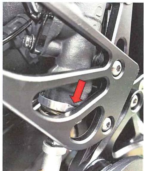
丸キャップボルト M8×45 と M8 ロックナットで、13.5mm 厚カラーと挟みピロボールに取り付け、マスターシリンダーとブレーキペダルを接合する。
