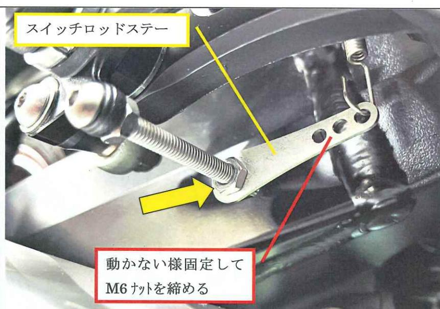
スイッチロッドステーの固定完了後、ブレーキランプ点灯のタイミングの微調整を、**ブレーキスイッチのナット**を回して行う。
