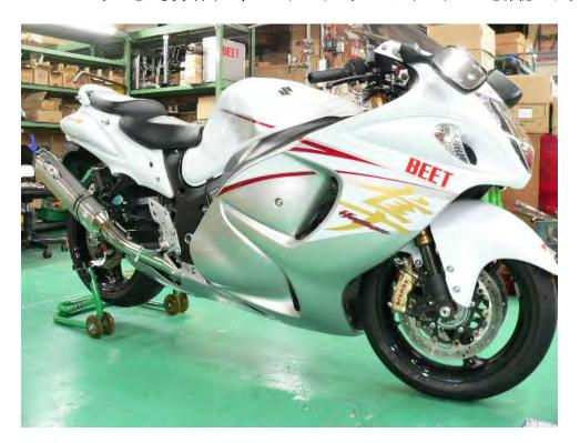
(2) マフラーをパーツクリーナなどで脱脂し、きれいにしてから ラジエターを取付けて、エンジンをかけて排気漏れがないか確認して カウルを取付けて、終了です。
