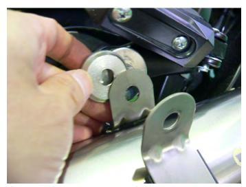
②付属のダンパーカラーを写真のように、サイレンサーバンドと車体の間に入れます。
