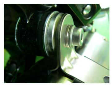
(1) 各部のクリアランスを確認してから、各部のボルトを本締めします。 カウルを一度取付けて、マフラーとカウルのクリアランスを確認します。
