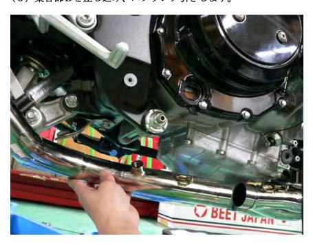
(4)集合部Bに、02センサーを取付けてから 写真のように、付属の $M8 \times 15$ ボルトでステーを仮止めします。
