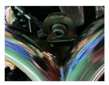
(5) テールパイプを差し込み、スプリング引きしてからサイレンサーを装着します。
