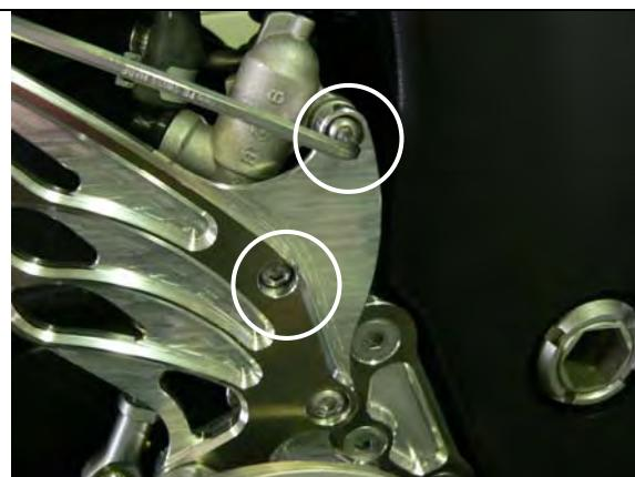
ブレーキリターンスプリングのナットを調整
