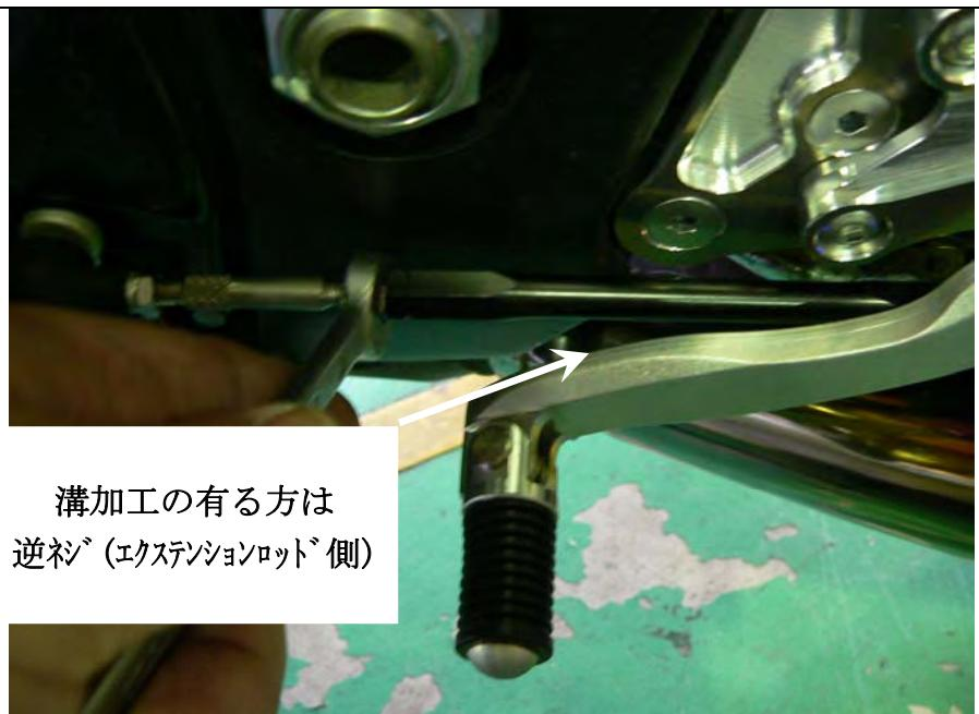
アルミチェンジロッドも回してお好みのペダルの垂れ角に調整して、ペダル位置が決まつたらそれぞれ 前出の三ヶ所の M6 ジャミナット を閉めてロックして下さい。
