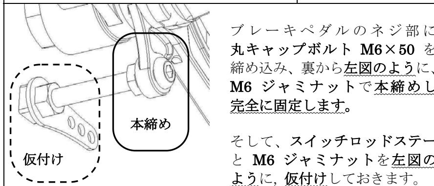
ブレーキペダルのネジ部に丸キャップボルト M6×50 を締め込み、裏から左図のように、M6 ジャミナットで本締めし完全に固定します。
