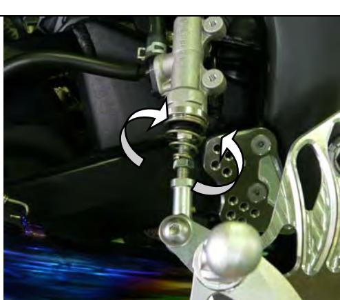
リアマスター シリンダーの M8 プッシュロッドボルトの先端に H/B ブレーキ側ステップのペダルカムに付いているピロボールの M8 ネジ穴を差し込んで取り付けブレーキ側 Assy ごと回して仮付けします。
