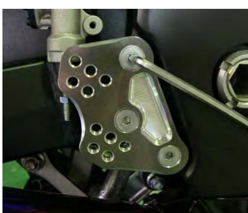
ブレーキ側ポジションプレートを皿キャップボルト M8×20 で、車体側に取り付け、本締めしておきます。
