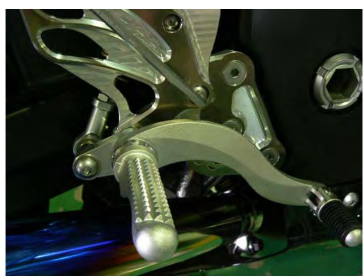
部品を取り付けたリアブレーキマスター シリンダーを、ステップホルダーの裏側から取り付け、付属のキャップボルト M6×20 を、ステップホルダーの表側から  $\phi 6.5 \text{ mm}$  穴に通し、リアブレーキマスター シリンダー側の M6 ネジで仮締めします。
