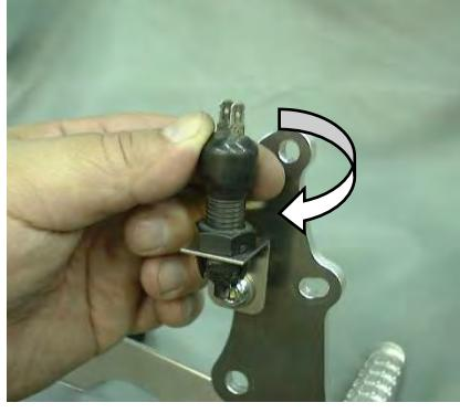
外しておいた純正ブレーキランプスイッチとアジャストナットを方向を間違えないように組み立て、H/B ブレーキ側ステップホルダーについているストップランプスイッチステーに、ナットのツメが引掛かるまで押し込んで下さい。
