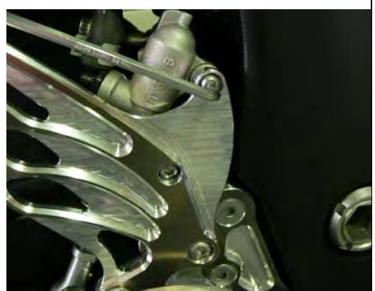
そして、ブレーキペダルの角度が合わない場合は、再度 取外して
