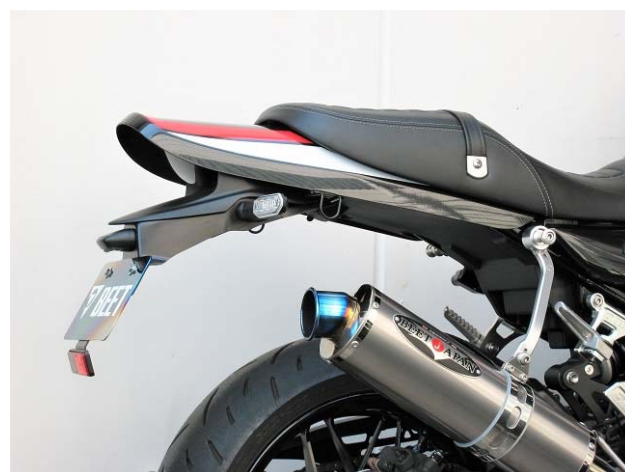
シートカウルとスモールリアフェンダー同時装着状態
