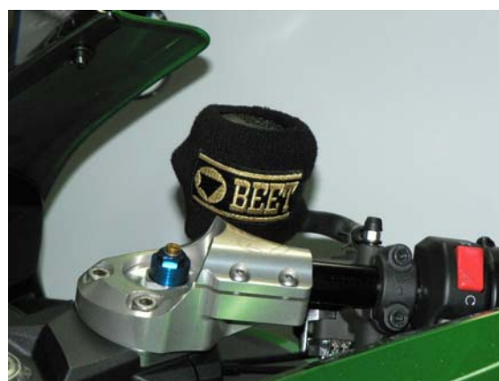
ブレーキマスターリザーバーカップのカバーとしての使用例
