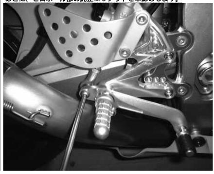
そして、**ブレーキペダル**の角度が合わない場合は、ピロボール先 ブレーキペダルの調整と同時に、ブレーキランプの点灯を確認
