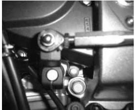
アルミチェンジロッドも回してお好みのペダルの垂れ角に調整して、ペダル位置が決またら M6 ジャミナット を閉めてロックして下さい。シフトチェンジ操作に不具合が無いか確認して下さい。
