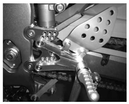
最初の取付け時は,一番前のポジションで取付けて下さい。<u>走行時は</u>必ず、ご自分に合った ポジション を選択し、チェンジ・ブレーキ両側のポジションが同じである事を確認して下さい。 純正チェンジカムにチェンジロッドのネジを少しかけて エンジン側の シフトチェンジシャフトにピロボールが 下側に なるように 取付け、純正 M6 六角ボルトで 仮締め します。
