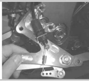
付属のブレーキスイッチスプリングの長さに合わせて、**スイッチ** ロッドステーとプレーキランプスイッチを (上図 )を参考に セットします。
