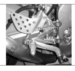
ブレーキ側ポジションプレートを STDボルトで、車体側に 取り付け、本締めしておきます。
