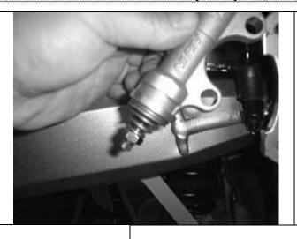
マスターシリンダーネジ部と、一番下のナットの下端 との 距離が 約7~8 mm程の距離 ( 左図矢印参照 )に調整し、 KF 8 ピロボールを仮止めします。
