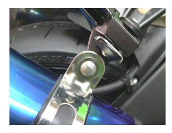
(3) テールパイプにサイレンサーを差し込み、スプリング引きして ノーマルボルト・ナットで、写真のように付属のサイレンサーバンド・バンドガスケット・ はめ込みカラーを使って仮止めします。
