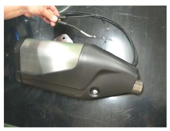
(2) ノーマルマフラーチャンバーボックスにテールパイプを差し込みます。 ※テールパイガスケットはノーマルをそのまま使用します!ガスケットの損傷が 激しい場合や排気漏れする場合は、新品に取り換えてください。
