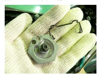
(3) テールパイプガスケットを付属の新品に取替えて テールパイプを差し込み、ノーマルクランプバンドで仮止めします!
