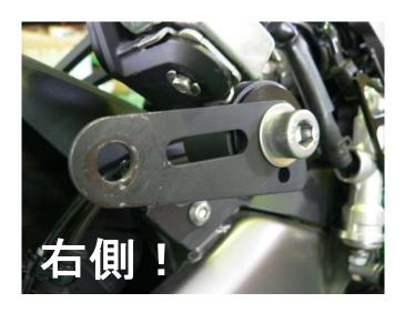
(6) サイレンサーをテールパイプに差し込み、スプリング引きしてから 付属の $M10 \times 20$  ボルト・ナットで仮止めします。
