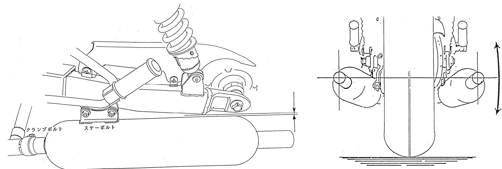
★最後にマフラー全体をしっかりと脱脂して下さい。拭き残しがあるとエンジン始動後に、排気熱により焦げつきが発生します。エンジンを始動させ、排気漏れのチェックを必ず行ってください。以上で取り付け作業は終了です。
