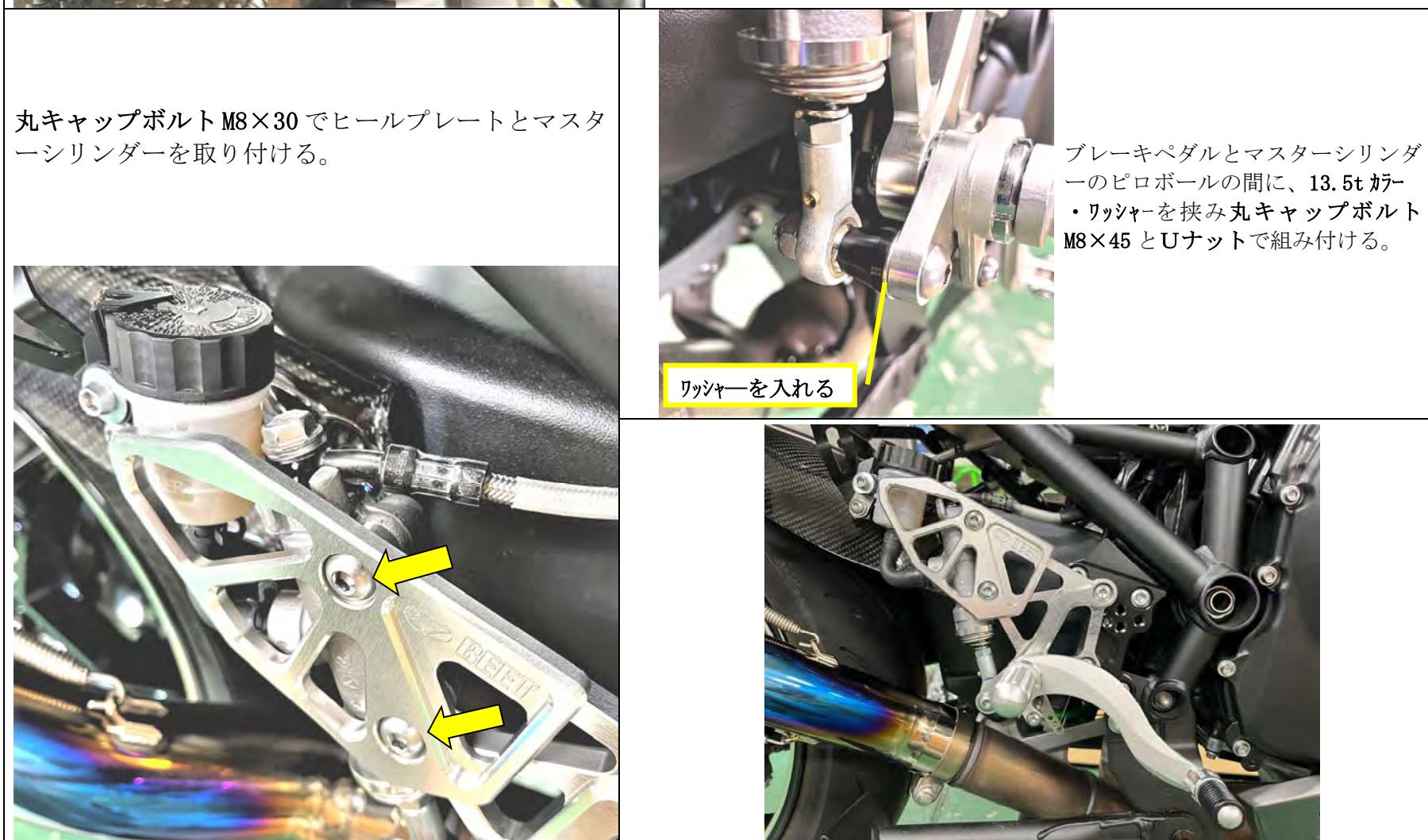
ブレーキペダルの高さが合わない場合は、純正 M8 ナットを緩めた状態で、プッシュロッドの六角部を 10 mm のスパナで回転させ調整します。
