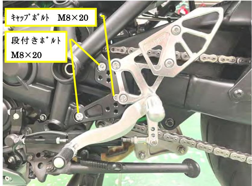
ポジション 1 のみ、純正チェンジカムの固定ボルトを取り外し、セレーション(ギザギザ)を 1 コマずらした位置で組付けて使用する。
