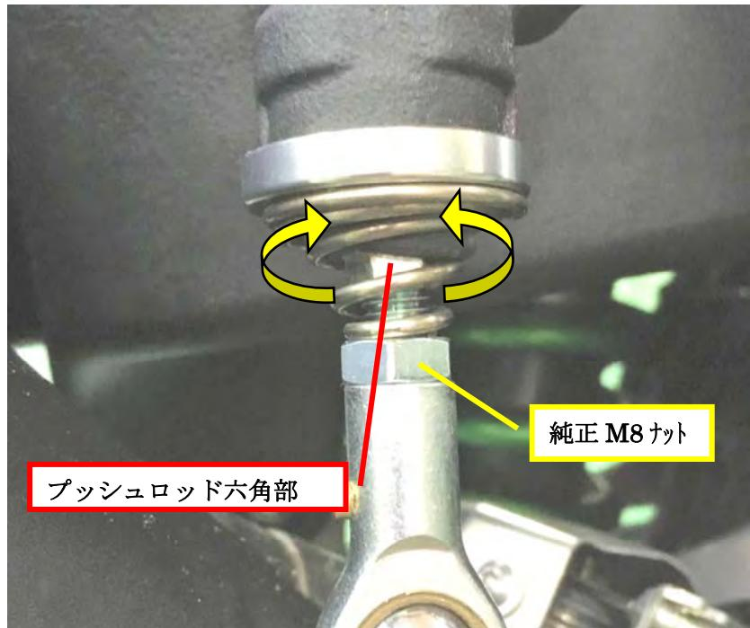
ブレーキペダルの高さ調整完了後、純正 M8 ナットを締めプッシュロッドが回らない様に固定します。
