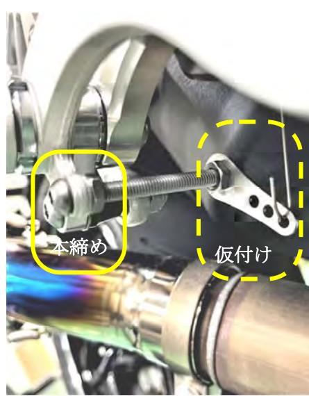
ブレーキペダルのネジ部に丸キャップボルト M6×60 を締め込み、裏から左図の様に、M6 ナットで本締めし完全に固定します。
