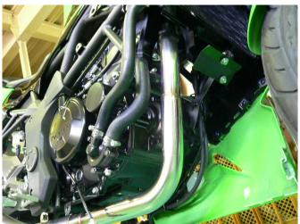
(3) 写真のように、エキパイ(テールパイプステー)を、ノーマルボルトに付属のワッシャを通し、 裏側から付属のM8ナットで仮止めします。
