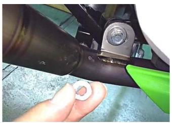
(4) 写真のようにサイレンサーを差し込み スプリング引きして、サイレンサーバンド、ノーマル取付ボルト/ナットで仮止めします。
