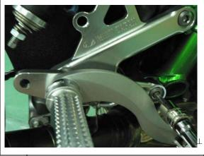
リアブレーキマスター シリンダーを、純正ヒ ールガードと共にST Dボルトで仮締めしま す。
