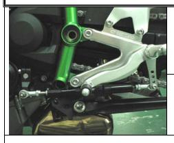
▶ チェンジ側STDステップの純正アルミシフトチェンジロッドの両端のM6ナットを 緩め、 純正アルミシフトチェンジロッド ・ シフタースイッチ、純正エンジン側ピロ ボール・純正チェンジカムを外します。
