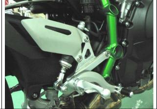
純正マスターシリンダーとペダル カムの組み付けが終わったら M8Uナットを仮締めして、
