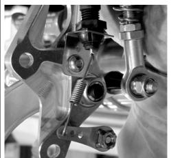
スイッチロッドステーの角度を、 ブレーキスイッチに取付けられ ているスプリングの長さに合わ せて、 ロッドステーがボルト から外れないようネジのかかり 量に注意して回しロッドステー の先端側の穴に、引っ掛けます。
